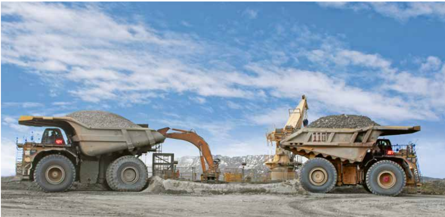
Camiones gigantes 797 descargando mineral en la chancadora primaria 初碎站矿车卸料
